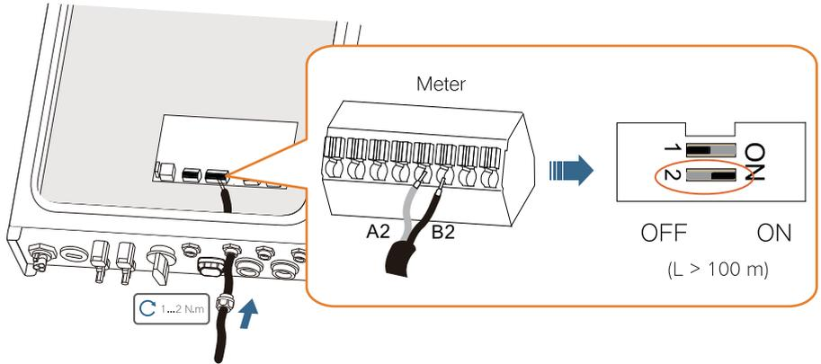
DO1 (Load control / Lastregelung / Controllo del carico / Contrôle de la charge / Laadregeling)
